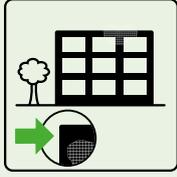
Witterungseinflüsse und der daraus resultierende Feuchtigkeitseintritt in den Untergrund führen zu Schädigungen in der Fassade. Zum Schutz solcher Fassaden aus mineralischen Baustoffen werden Imprägnierungen eingesetzt, wonach die Oberfläche wasserabweisend ist. Diese Hydrophobierungsmittel dringen tief ein und trocknen rückstandslos aus, um die Optik der Fassade durch die Imprägnierung nicht zu beeinträchtigen.
