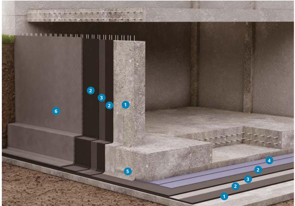
Ein vollständiges Abdichtungssystem im Neubau schließt auch eine Abdichtung der Bodenplatte ein. Im Gegensatz zur Abdichtung oberhalb der Bodenplatte bleibt das Bauteil bei einer Abdichtung unterhalb der Bodenplatte selbst trocken.
