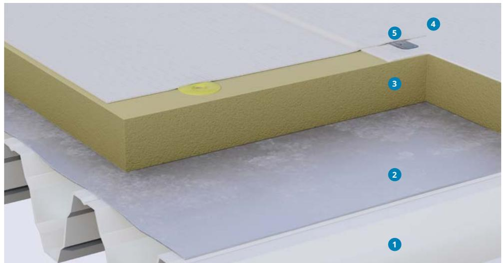
Die herkömmliche Art der Verlegung von FPO-Bahnen (international auch TPO-Bahnen) ist die mechanische Befestigung. Hierbei wird die Dachdichtungsbahn im tragenden Untergrund der Dachkonstruktion verankert. Diese besteht üblicherweise aus einer Holzverschalung, Stahltrapezblechen oder einer Betondecke. Die Verankerung im Untergrund erfolgt meist durch die Wärmedämmung hindurch. Dies macht spezielle Befestigungselemente erforderlich, die verhindern, dass Wasser in die Wärmedämmung eindringen kann.
