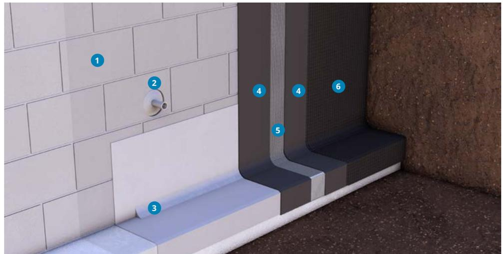
Die Abdichtung mit bituminösen Abdichtungssystemen gehört zu den Standardlösungen für die Außenabdichtung von Kellern. Die Systeme werden pastös aufgebracht und dichten daher nahtlos ab. Sie sind einfach und sicher zu verarbeiten und rissüberbrückend.
