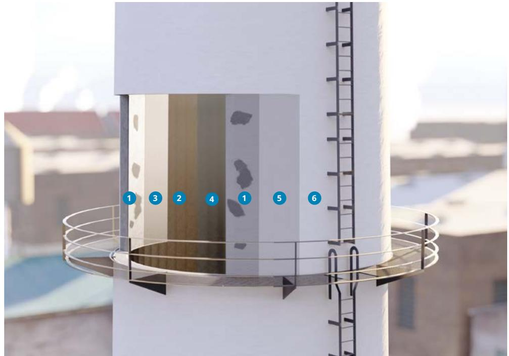
Ein Beispiel für den schweren Korrosionsschutz gegen säurehaltige Dämpfe und Tropfwasser ist die Innenbeschichtung von Industrieschornsteinen aus Mauerwerk oder Beton.
