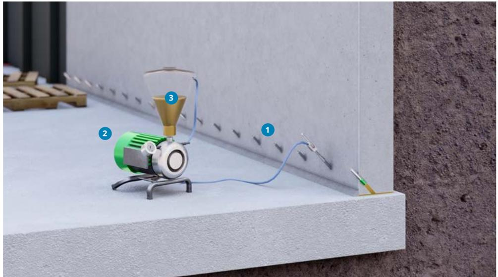
Zur nachträglichen Abdichtung des Wand-Boden-Anschlusses müssen die Bohrlöcher diagonal zur Arbeitsfuge gebohrt werden. Das Bohrloch sollte die Arbeitsfuge etwa in der Bauteilmitte treffen.
