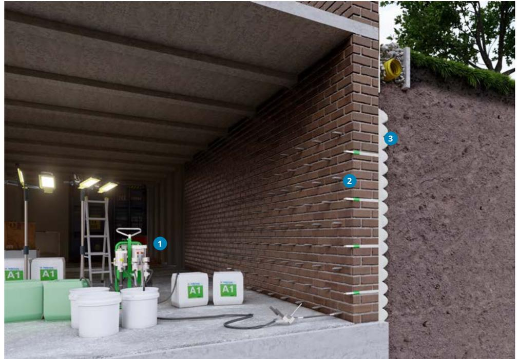
Kelleraußenabdichtung von Innen? Im Instandsetzungsfall ist es nicht immer möglich, die Kelleraußenwände freizulegen, z. B. weil die aufzugrabende Fläche überbaut oder aus anderen Gründen nicht zugänglich ist. Hier wäre zunächst an eine Innenabdichtung (Negativabdichtung) zu denken. Doch in einigen Fällen z. B. bei historischen Bauwerken oder bei besonderen architektonischen Anforderungen kommt auch dies nicht in Frage.
