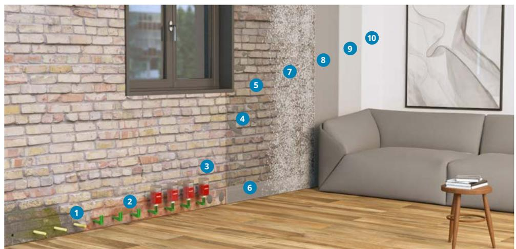
Aufsteigende Feuchtigkeit im Mauerwerk ist die Ursache von durchfeuchteten Wänden, Salzausblühungen, abblättrender Farbe oder abplatzendem und mürbem Putz. Der Einbau einer Horizontalsperre vermeidet diese Schäden dauerhaft.
