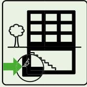
Bauteilrisse sind strukturelle Schwachpunkte. Sie verkürzen die Lebensdauer des gesamten Bauwerks, weil die Bausubstanz durch eindringendes Wasser merklich geschwächt wird. Ein elastischer oder kraftschlüssiger Rissverschluss ist erforderlich. Dazu wird mittels einer Druckinjektion über Injektionspacker der Rissverlauf mit einem Polyurethanharz oder Epoxidharz verfüllt.
