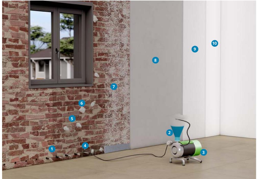
Schnell und effektiv: Der Einbau einer Horizontalsperre im Druckinjektionsverfahren. Wenn im Mauerwerk sichergestellt werden kann, dass keine Hohlräume oder Risse vorhanden sind, kann die Horizontalsperre auch im Druckinjektionsverfahren eingebaut werden. Risse und Hohlstellen in der Wand sind ggf. vorab über das Bohrloch mit z. B. KÖSTER Injektionsleim 1K zu verfüllen. Danach wird das Bohrloch noch einmal aufgebohrt.
