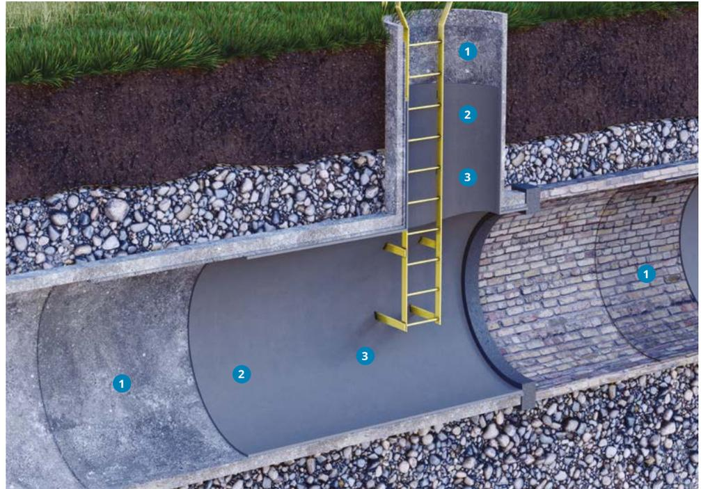
In Abwasserkanälen steht häufig die mechanische und chemische Stabilität im Vordergrund. Hohe und niedrige pH-Werte, sowie abrasive Abnutzungen sind die Anforderungen an den Oberflächenschutz, die eine längere Nutzungszeit sichern.
