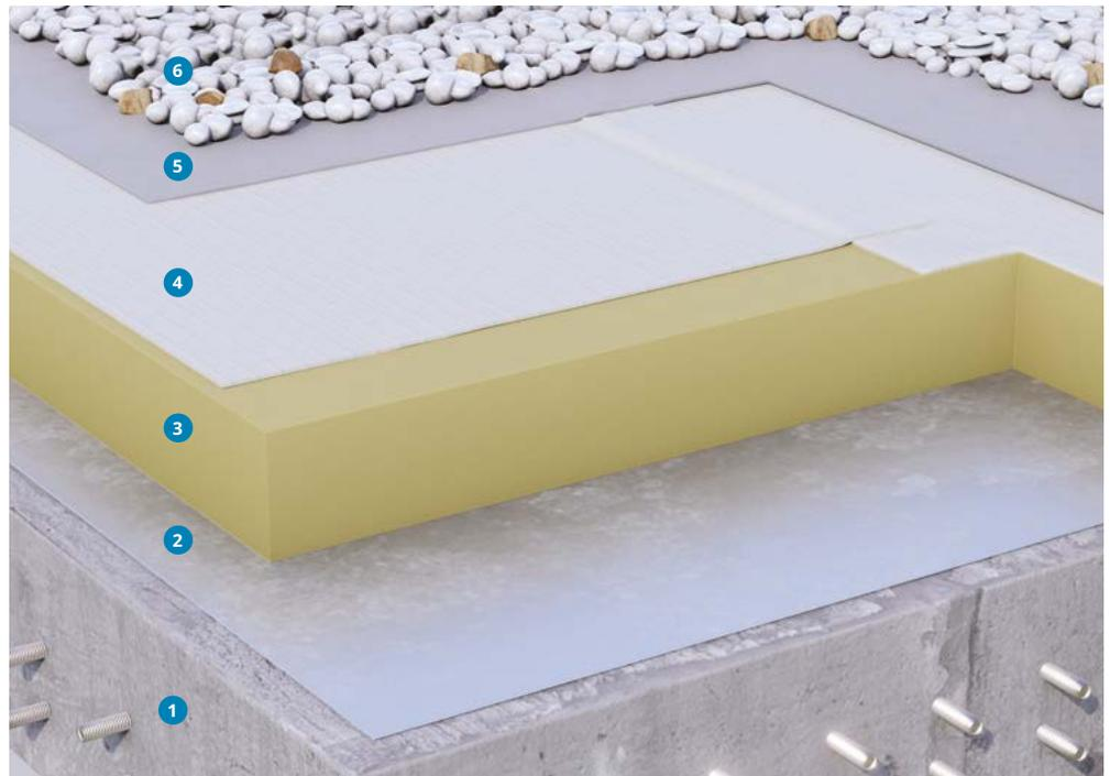
Eine schnelle und sehr sichere Ausführung einer Abdichtung mit KÖSTER FPO-Bahnen (international auch TPO-Bahn) ist die lose Verlegung mit Auflast. Eine Auflast besteht beispielsweise aus einer Dachbegrünung oder einer Kiesschüttung und hat die Aufgabe, die Dachbahnen gegen Windlasten zu sichern. Auch architektonisch anspruchsvolle Dachformen können mittels der losen Verlegung realisiert werden.
