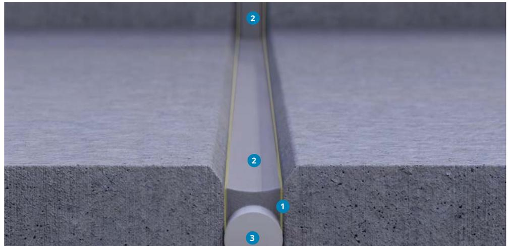
Fugen sind meist thermischen oder anderen Bewegungen ausgesetzt und müssen daher elastisch abgedichtet werden. Entscheidend für eine Fugenabdichtung ist nicht nur die Haltbarkeit des Fugenmaterials, sondern dass es dauerhaft an den Flanken haftet. Der Untergrund muss tragfähig, sauber, frei von trennenden Substanzen, losen Bestandteilen sowie trocken sein.
