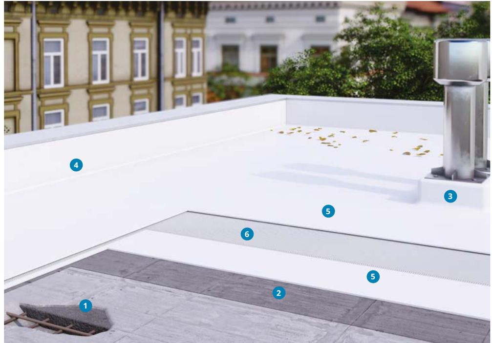
Eine schnelle und einfache Möglichkeit der Instandsetzung von Dächern ist der Einsatz von Flüssigkunststoffen. Eine sorgfältige Untergrundvorbereitung ist die Voraussetzung für die Dauerhaftigkeit der Maßnahme. Der Untergrund muss fest, tragfähig und frei von haftungsmindernden Substanzen sein. Auf Betonuntergründen empfiehlt sich eine Abdichtung mit KÖSTER NB 1 um einen einheitlichen geeigneten Untergrund für die rissüberbrückende Abdichtung zu schaffen.
