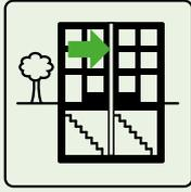
Fugen in Bauteilen sind notwendig, um Bauteilbewegungen aufzunehmen. Durch eine sichere Fugenabdichtung werden diese Bauteilfugen dauerhaft elastisch, formstabil und UV-beständig abgedichtet. Dadurch werden auch zukünftig Bauteilbewegungen ermöglicht, ohne zu Schäden zu führen.
