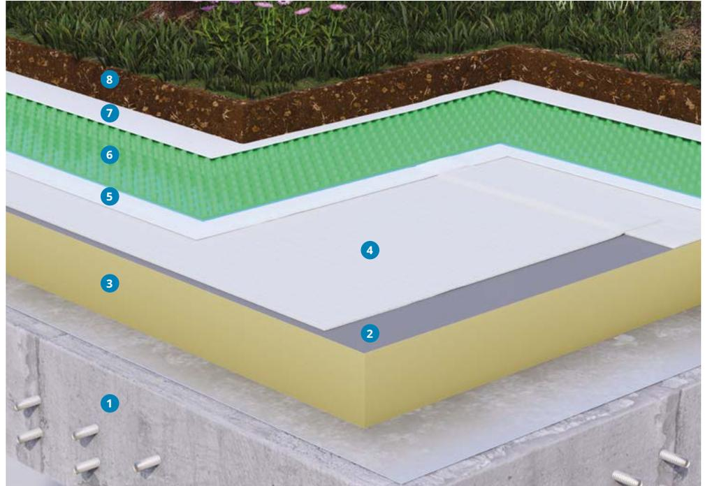
Gründächer werden immer beliebter und verbreiteter, da sie eine ökologischere Lösung für die Überdachung darstellen, Ästhetik vereinen und einen Lebensraum für das Gedeihen der Natur bieten. Weitere Vorteile sind die Fähigkeit, einen Teil des Regenwassers zurückzuhalten, die Eindämmung des städtischen Wärmeeffekts, die Verbesserung der Luftqualität, die Wirkung als Flammschutzmittel, die Lärminderung durch absorbierende Dezibel und viele andere.
