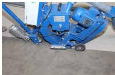
**2. Для создания шероховатой и впитываемой поверхности новые основания также обрабатываются дробеструйным методом или шлифованием.**
